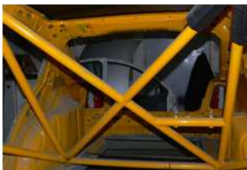
Obrázek 32 Výztužný kříž mezi zadními vzpěrami
