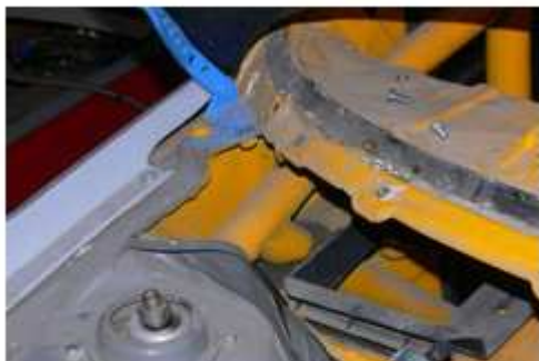
Obrázek 30 Detail upevnění bezpečnostního rámu k uložení předního
