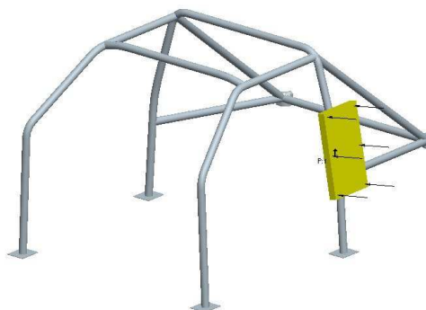
Obrázek 27 Model zkoušky bočního zatížení [4]
