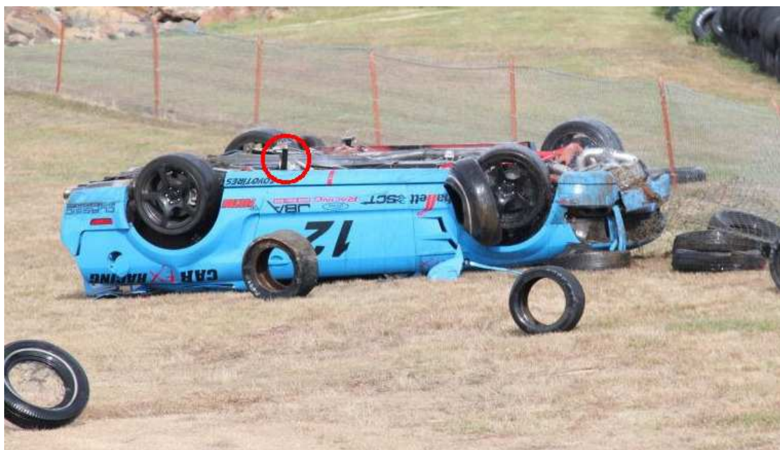
Obrázek 7 Důsledek nedostatečné bezpečnostní konstrukce. Zakroužkován svislý sloupek, který prošel skrz podlahu vozidla.[11]
