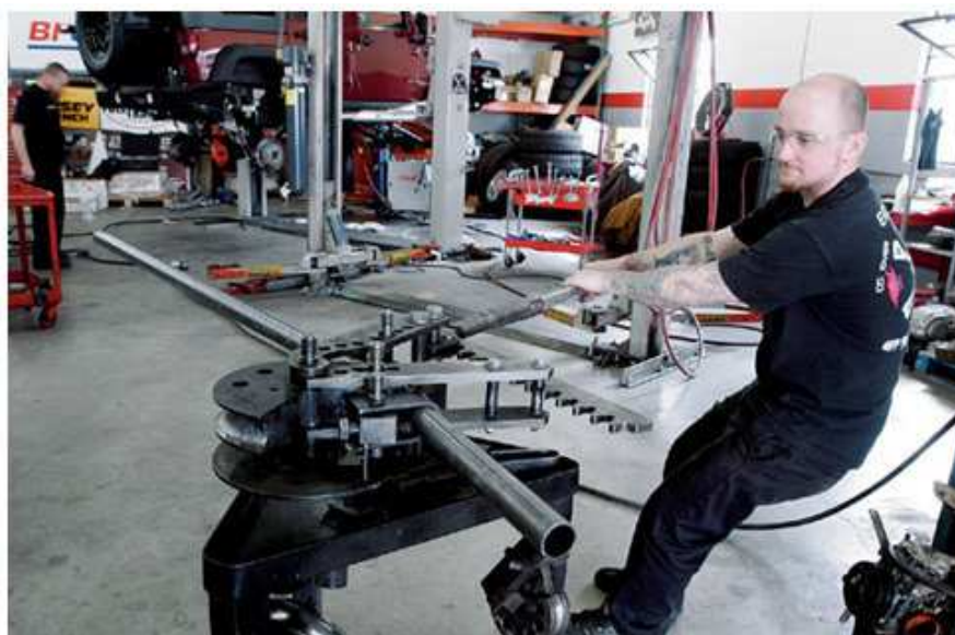
Obrázek 25 Ohýbání trubek pro rám na ručním ohýbacím zařízení [13]
